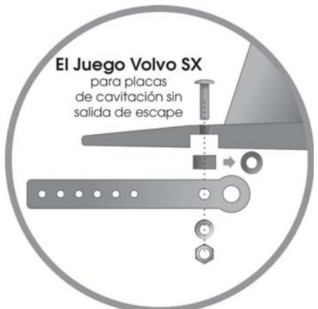
**Nota:** Las contratuerca con inserto de nylon y las almohadillas adhesivas han sido diseñadas para ser usadas una sola vez solamente.
