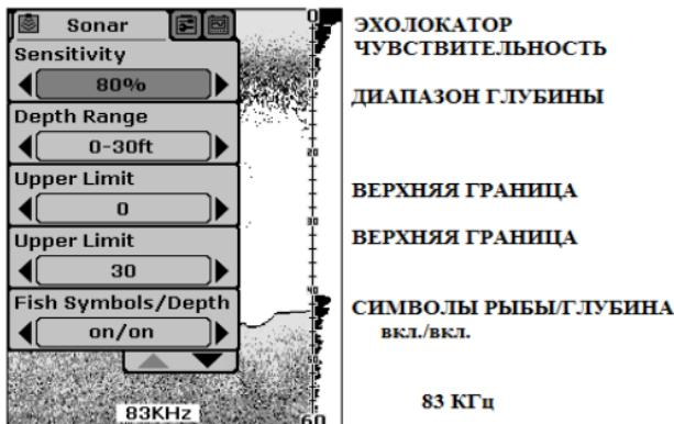
Система меню имеет 3 вкладки: «Эхолокатор», «Установка» и «Вперед». Можете нажать клавишу меню Menu Key для переключения между различными вкладками меню.
