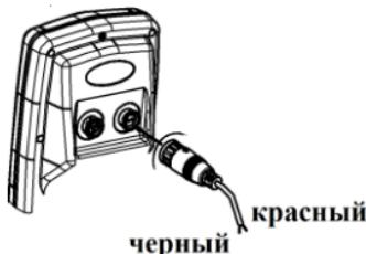
**2.** Подключите ЧЕРНЫЙ провод к минусу (-) клеммы батареи или соответствующего заземления.
